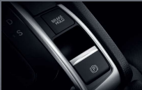
Electric Parking Brake ระบบเบรคมือไฟฟ้าใช้งานง่าย เพียงใช้นิ้ว กดสวิตช์ติดตั้งอยู่ใต้ออกันะกลาง เมื่อต้องการใช้เบรคมือ และระบบจะคลายเบรค โดยอัตโนมัติเมื่อเหยียบคันเร่ง (ระบบจะคลายเบรคในกรณีที่ใช้ขึ้นที่ ลาดชันอัตโนมัติอยู่เท่านั้น)
