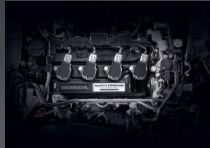
เครื่องยนต์ VTEC TURBO 1.5 ลิตร 173 แรงม้า
