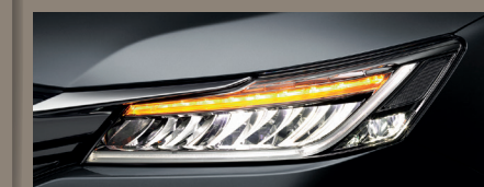
Active Cornering Light (ACL) ไฟส่องสว่างด้านข้างอัตโนมัติช่วยเพิ่มความสว่างด้านข้างของรถขณะเลี้ยวในเวลากลางคืน
