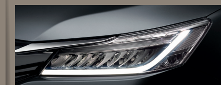
Daytime Running Lights (DRL) ไฟส่องสว่างสำหรับการขับในเวลากลางวันแบบ LED
