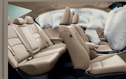
ระบบถุงลม 6 ตำแหน่ง ถุงลมคู่หน้าอัจฉริยะ Dual i-SRS ถุงลมด้านข้างคู่หน้าอัจฉริยะ i-Side Airbags และน้ำหนักรถด้านข้าง Side Curtain Airbags ช่วยลดอาการบาดเจ็บของผู้ขับขี่และผู้โดยสารในทุกสถานการณ์การขับที่ปลอดภัยที่สมบูรณ์แบบ
