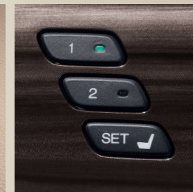
Memory Seat ระบบบันทึกตำแหน่งเบาะนั่งของผู้ขับขี่
