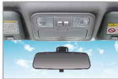
กระจกมองหลังป้องกันแสงสะท้อน ปรับลดแสงไฟจากรถคันข้างหลัง เพื่อเพิ่มความปลอดภัยในการขับขี่ ในเวลากลางคืน
