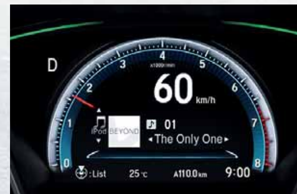
ECO Coaching ระบบแสดงผลการขับขี่แบบประหยัดน้ำมัน ช่วยแนะนำให้ผู้ขับขี่ใช้เชื้อเพลิงอย่างรู้คุณค่า โดยวัดจากการเหยียบเบรกและคันเร่ง ซึ่งจะแสดงผลด้วยการเปลี่ยนสีที่มาตรวัดเรืองแสง
