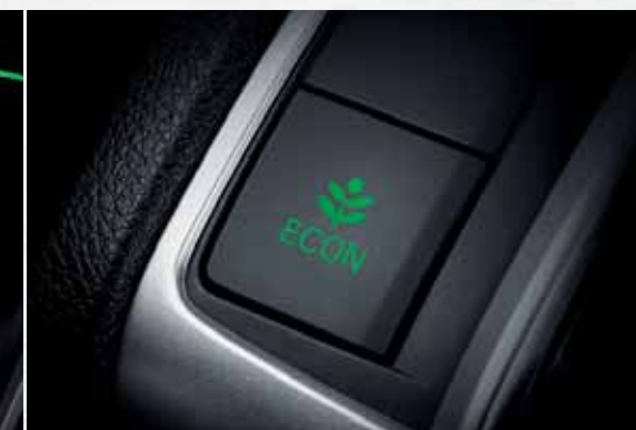
ECON Mode ระบบช่วยลดการใช้พลังงานที่สิ้นเปลือง โดยปรับการทำงานของเครื่องยนต์และระบบเกียร์ให้สัมพันธ์กัน เพื่อลดอัตราการสิ้นเปลืองเชื้อเพลิง ทั้งยังช่วยปรับการทำงานของระบบปรับอากาศและการหมุนเวียนอากาศภายในห้องโดยสาร ให้เหมาะสมทำให้เครื่องยนต์ใช้พลังงานอย่างมีประสิทธิภาพมากขึ้น
