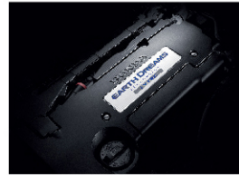
เครื่องยนต์ 2.4 ลิตร DOHC i-VTEC Earth Dreams Technology 175 แรงม้า
