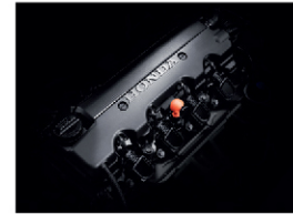
เครื่องยนต์ 2.0 ลิตร SOHC i-VTEC 155 แรงม้า
