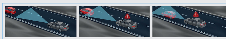
Collision Mitigation Brake System (CMBS) ระบบเตือนการชนด้านหน้าด้วยเรดาร์ พร้อมระบบช่วยเบรก
