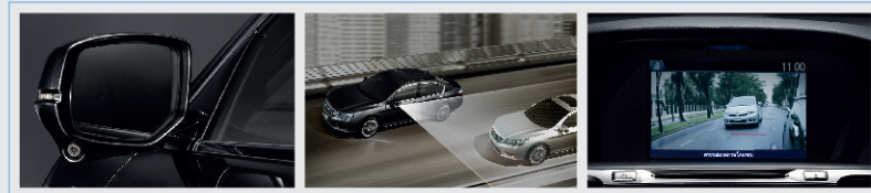
Honda LaneWatch ระบบแสดงภาพมุมมองด้านข้างด้านหลังบนหน้าจอแสดงผล โดยจะแสดงภาพมุมมองด้านข้างด้านหลังบนหน้าจอแสดงผลขนาด 8 นิ้ว
