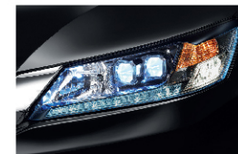
Active Cornering Light (ACL) ไฟส่องสว่างด้านข้างอัตโนมัติ ช่วยเพิ่มความสว่างด้านข้างของรถขณะเลี้ยวในเวลากลางคืน
