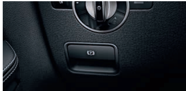
เบรกมือควบคุมการทำงานด้วยระบบไฟฟ้า (electric parking brake)
