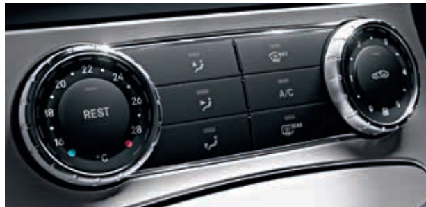
ระบบควบคุมอุณหภูมิ THERMATIC
