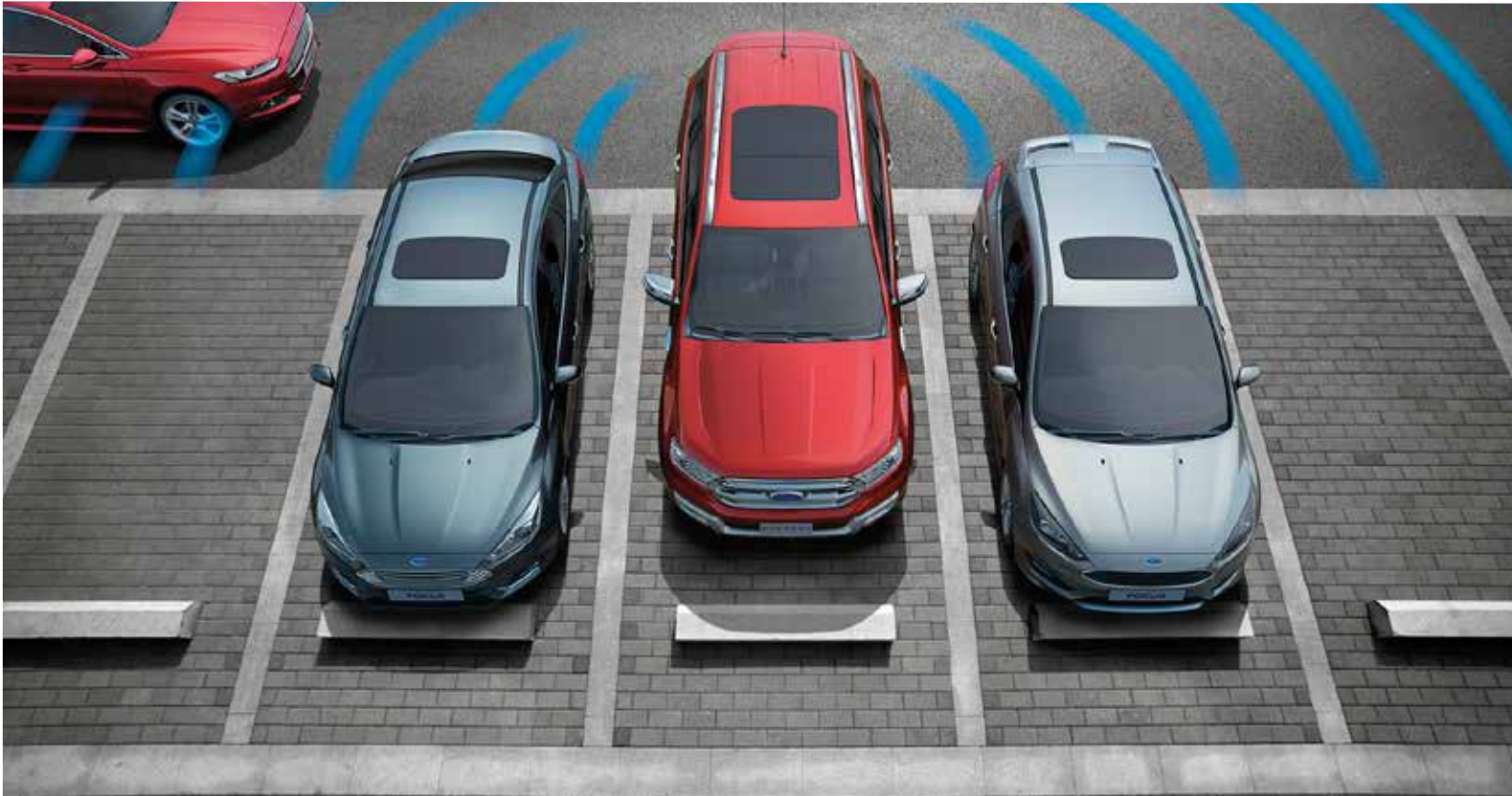
ระบบตรวจจับรถขณะออกจากช่องจอด (Cross Traffic Alert) ระบบจะแจ้งเตือนหากมีรถวิ่งตัดผ่านด้านหลังก่อนที่คุณกำลังออกรถออกจากช่องจอดอีกด้วย
