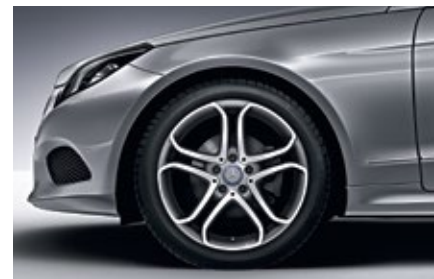
ล้ออัลลอยแบบ 5 ก้านคู่ ขนาด 18" พร้อมยางหน้า ขนาด 245/40 R18 และยางหลังขนาด 265/35 R18 สำหรับรุ่น E 200 Edition E
