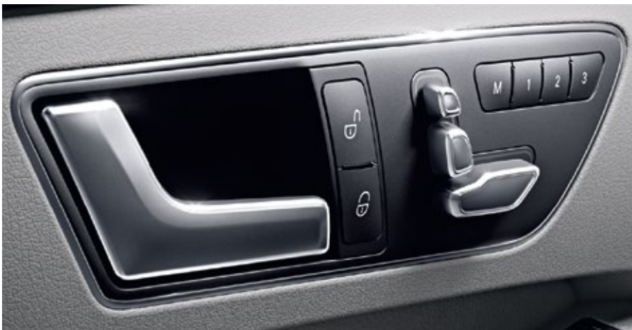
เบาะนั่งคู่หน้าปรับระดับด้วยระบบไฟฟ้า พร้อมหน่วยบันทึกความจำ สำหรับตำแหน่งที่นั่ง พวงมาลัย และกระจกมองข้าง
