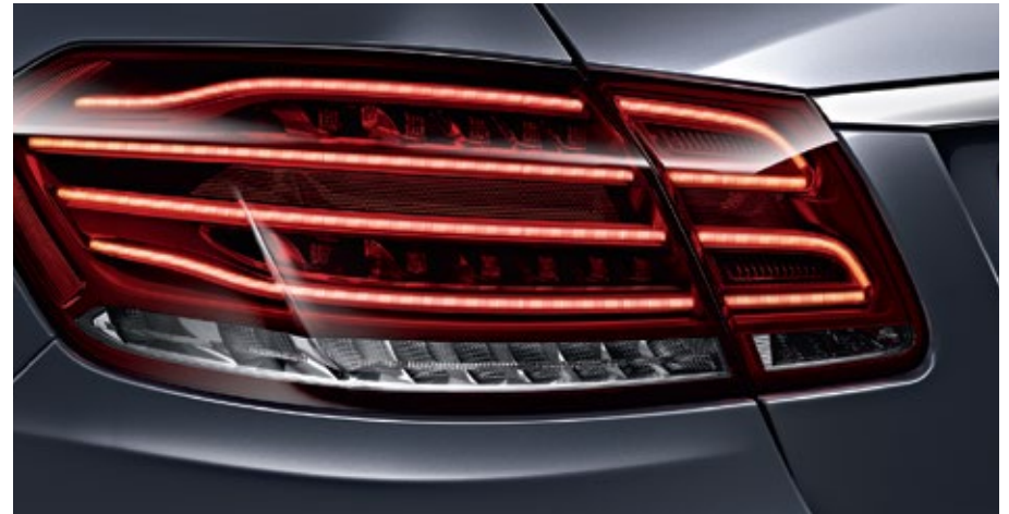
ไฟท้ายแบบ LED fibre-optic technology
