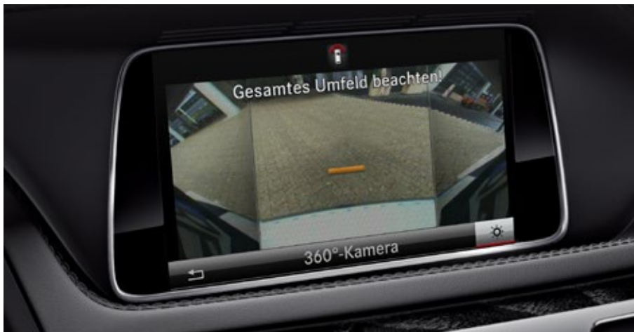
กล้องแสดงภาพรอบทิศทาง เฉพาะรุ่น E 300 BlueTEC HYBRID Exclusive และรุ่น E 300 BlueTEC HYBRID AMG Dynamic
