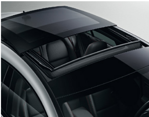
หลังคาพาโนรามากระจกเลื่อนเปิด-ปิดได้ด้วยระบบไฟฟ้า (Electric panoramic sliding glass sunroof) สำหรับรุ่น CLA 250 AMG Dynamic และ CLA 250 Shooting Brake AMG Sport
