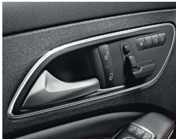
เบาะนั่งสำหรับผู้ขับขี่และผู้โดยสารด้านหน้าปรับระดับ ด้วยระบบไฟฟ้า พร้อมหน่วยบันทึกความจำ
