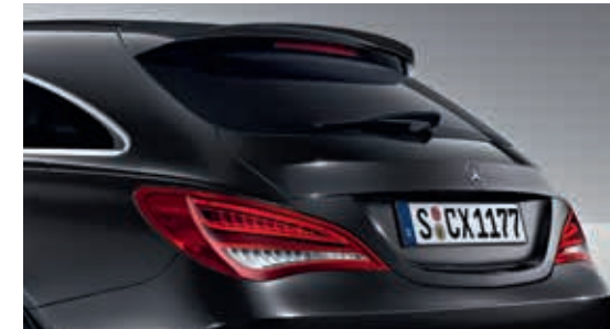
บานประตูท้ายดีไซน์ลาดเอียงและกระจกหลังบานใหญ่ พร้อมที่ปัดน้ำฝนหลัง/สปอยเลอร์หลังพร้อมไฟเบรกดวง ที่ 3 สำหรับรุ่น CLA 250 Shooting Brake AMG Sport
