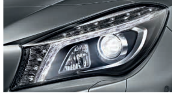
ไฟหน้าแบบไบซีนอน (bi-xenon) พร้อมระบบฉีดน้ำทำความสะอาดไฟหน้า
