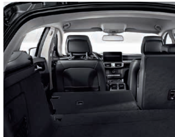
ฟังก์ชัน EASY - PACK quickfold สำหรับการพับพนักพิงเบาะนั่งด้านหลัง ในลักษณะ 1/3 หรือ 2/3 สำหรับรุ่น CLS 250 CDI Shooting Brake AMG Premium
