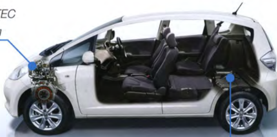
ชุดหน่วยควบคุมอัจฉริยะ: IPU (Intelligent Power Unit) พร้อมแบตเตอรี่ไฮบริดขนาดกะทัดรัด และน้ำหนักเบา
