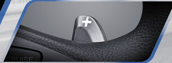
ระบบควบคุมการเปลี่ยนเกียร์ที่พวงมาลัยแบบ 7 สปีด (7-speed Paddle Shift)
