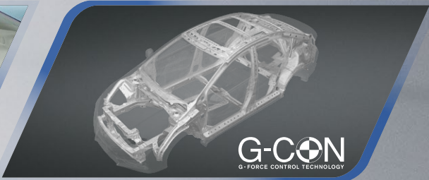
โครงสร้างตัวถังบิรภัย G-Force Control หรือ G-CON ปกป้องห้องโดยสารจากการชนรอบทิศทาง
