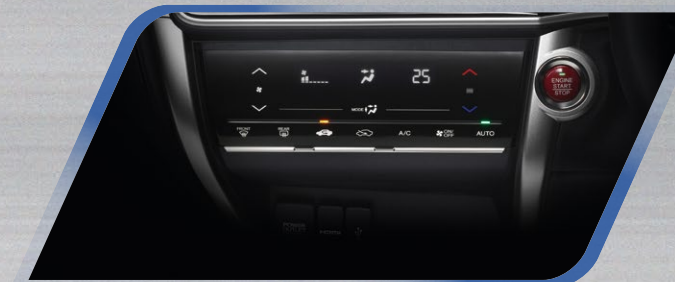
ระบบปรับอากาศอัตโนมัติพร้อมแผงควบคุมแบบสัมผัส
