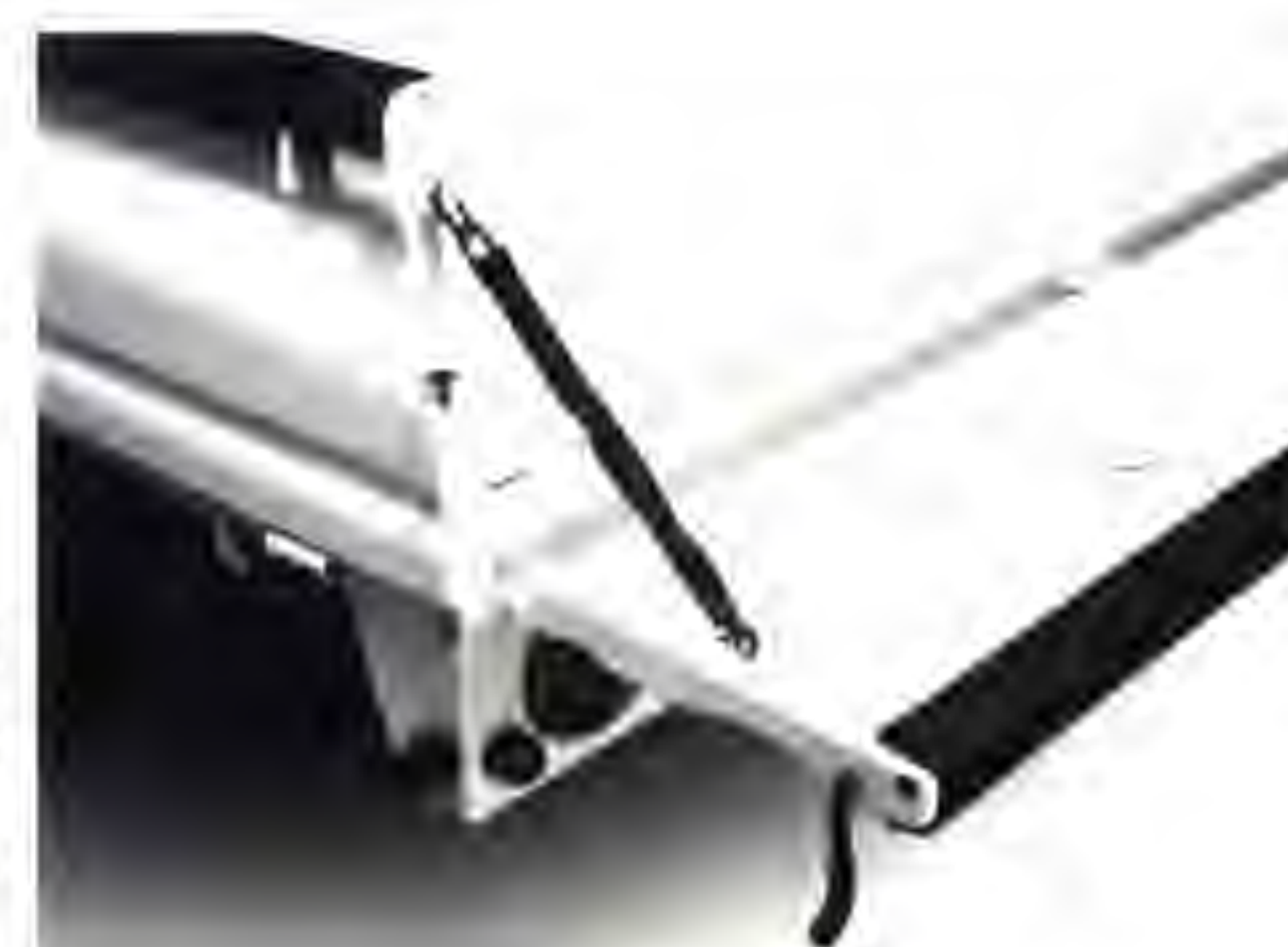
โช้คกระดุมก้าน เพิ่มความแข็งแรง ในการรับน้ำหนัก
