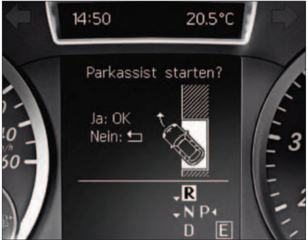
ระบบช่วยการนำรถเข้าจอดอัตโนมัติ (Active Parking Assist)
