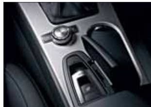
Controller และสวิตช์ควบคุมการเปิด - ปิด หลังคา
