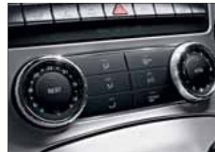
ระบบควบคุมอุณหภูมิ THERMATIC
