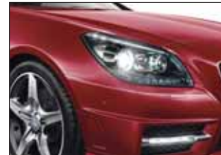
ไฟหน้าแบบไบซีนอน (bi-xenon) และไฟ daytime สำหรับการขับขึ้นเวลากลางวัน แบบ LED
