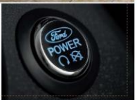
All-New Fiesta with Ford Power Start สามารถกดปุ่มสตาร์ทเครื่องยนต์ได้จากที่นั่ง จากเบาะนั่ง และไม่ต้องกดปุ่มสตาร์ทเครื่องยนต์ จากที่บังคับทิศทางของรถ
