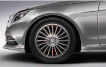
ล้ออัลลอยขนาด 17" พร้อมยาง Run-flat tyres ขนาด 245/45 R17 สำหรับรุ่น E 300 BlueTEC HYBRID Executive
