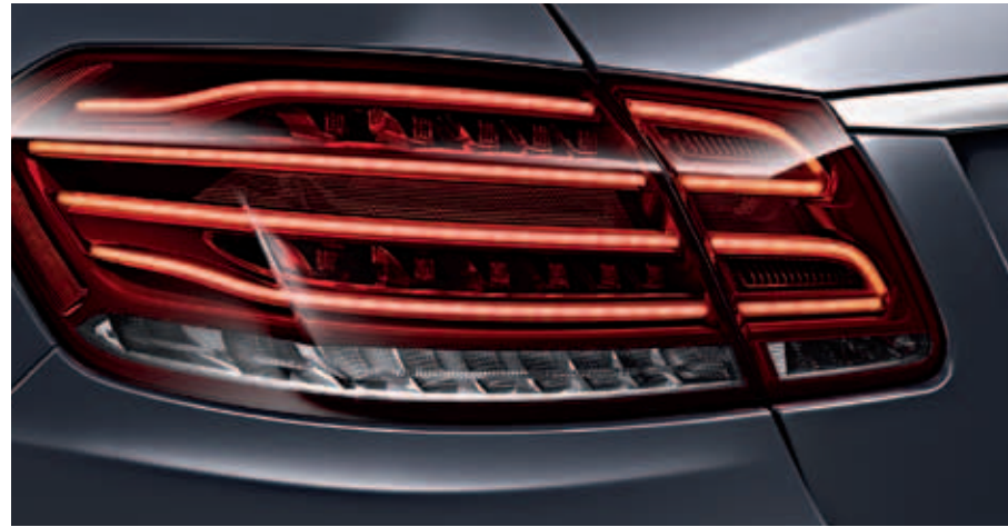
ไฟท้ายแบบ LED fibre-optic technology
