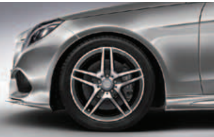
ล้ออัลลอย AMG ขนาด 18" พร้อมยางหน้า ขนาด 245/40 R18 และยางหลังขนาด 265/35 R18 สำหรับรุ่น E 300 BlueTEC HYBRID AMG Dynamic และรุ่น E 300 BlueTEC HYBRID Estate AMG Dynamic
