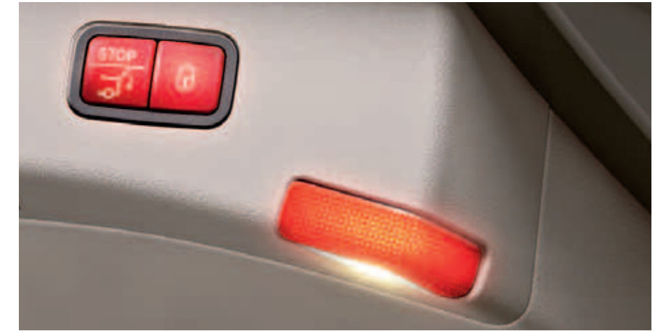
ระบบปิดฝากระโปรงท้าย/บานประตูอัตโนมัติเฉพาะรุ่น E 300 BlueTEC HYBRID AMG Dynamic และรุ่น E 300 BlueTEC HYBRID Estate AMG Dynamic
