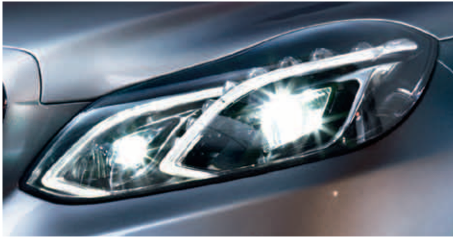
ไฟหน้าแบบ LED Intelligent Light System เฉพาะรุ่น E 300 BlueTEC HYBRID Executive, รุ่น E 300 BlueTEC HYBRID AMG Dynamic และรุ่น E 300 BlueTEC HYBRID Estate AMG Dynamic
