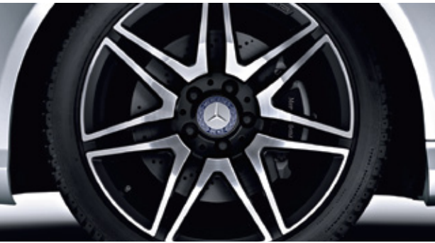
ล้ออัลลอยดีไซน์สปอร์ตจาก AMG 7 ก้านคู่ แบบ two-tone ขนาด 18" พร้อมยางหน้า 225 / 40 R18 และยางหลัง 255 / 35 R18
