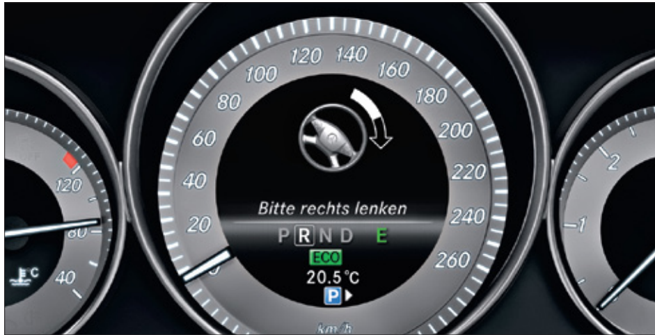
เซ็นเซอร์ช่วยในการนำรถเข้าจอด (PARKTRONIC) พร้อมแนะนำการจอด (Parking Guidance)
