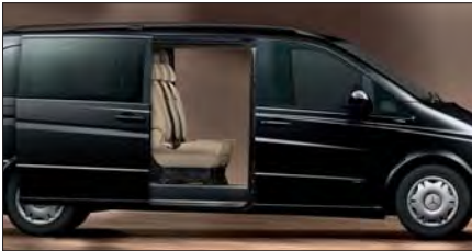
ประตูบานเลื่อนซ้าย-ขวา เปิด-ปิดด้วยระบบไฟฟ้า พร้อมระบบตรวจสิ่งกีดขวางอัตโนมัติ
