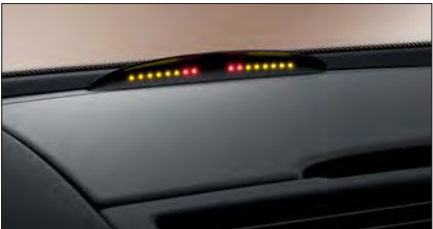
เซ็นเซอร์ช่วยในการนำรถเข้าจอด (PARKTRONIC) พร้อมจอ LED แสดงระยะ*
