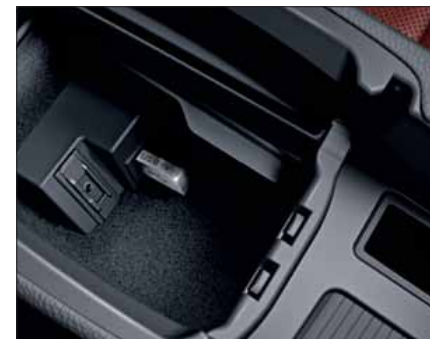
ช่องสัญญาณเชื่อมต่อ USB บริเวณพนักวางแขนกลางเบาะหน้า
