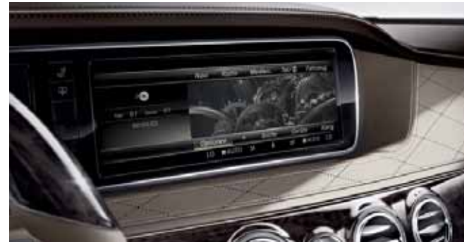
แผงหน้าปัดควบคุมการทำงานของวิทยุ - ดีวีดี และเชื่อมต่ออินเทอร์เน็ต พร้อม controller และระบบนำทาง (navigation system) ด้วยระบบ COMAND Online
