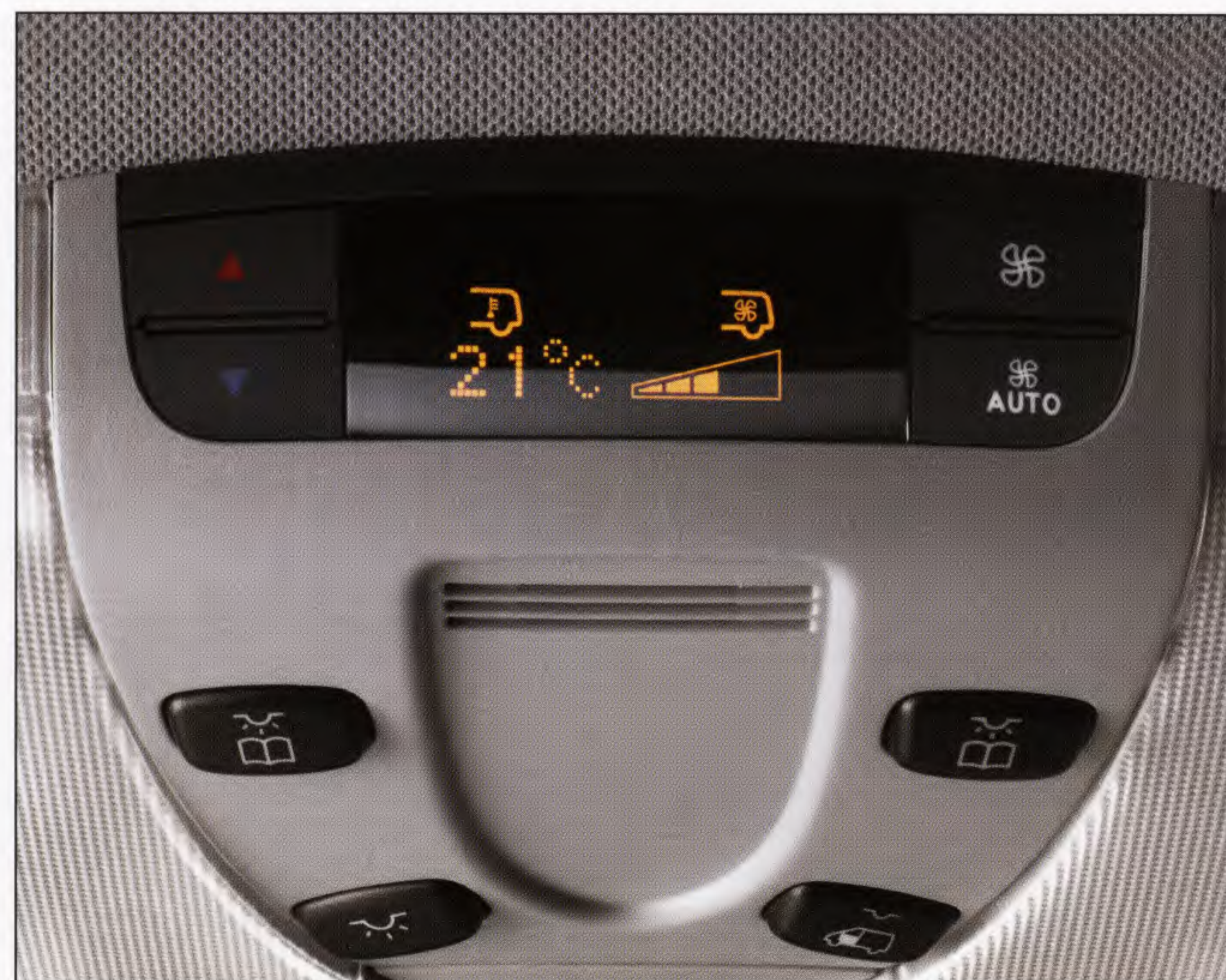
ระบบควบคุมอุณหภูมิอัตโนมัติแบบ TEMPMATIC สำหรับผู้โดยสารด้านหลัง
