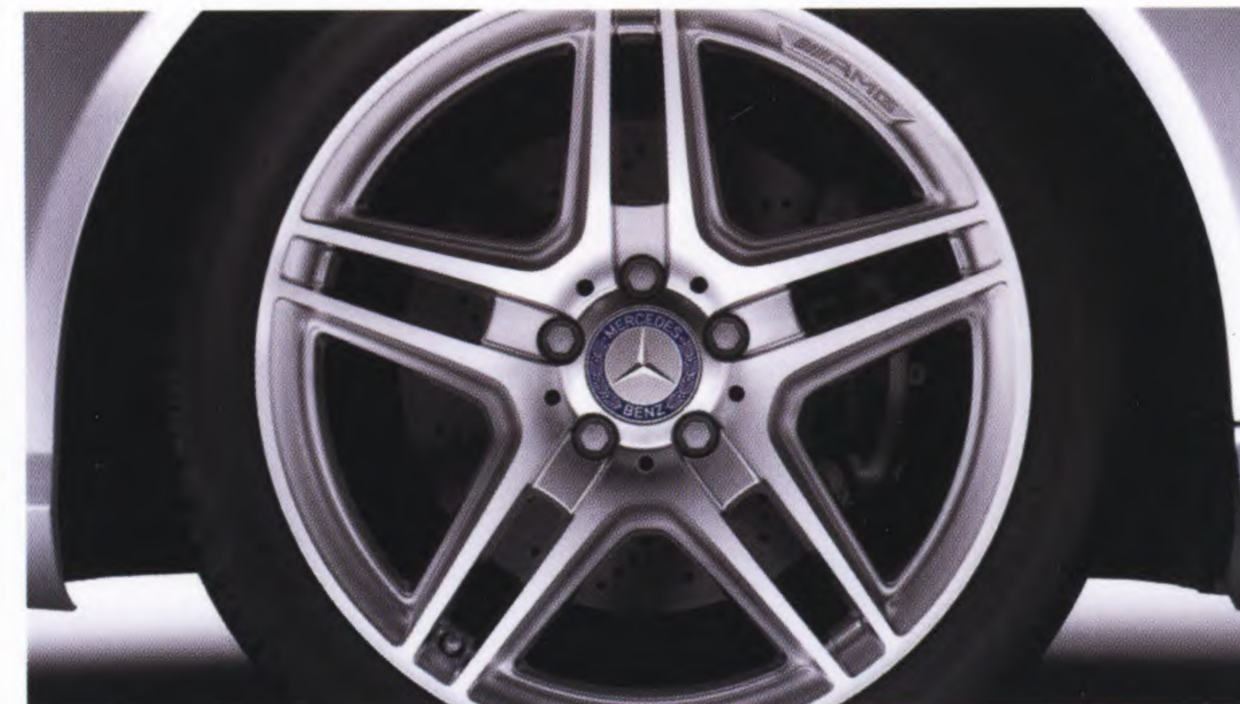
ล้ออัลลอย AMG ขนาด 18" พร้อมยางหน้า 225 / 40 R18 และยางหลัง 255 / 35 R18
