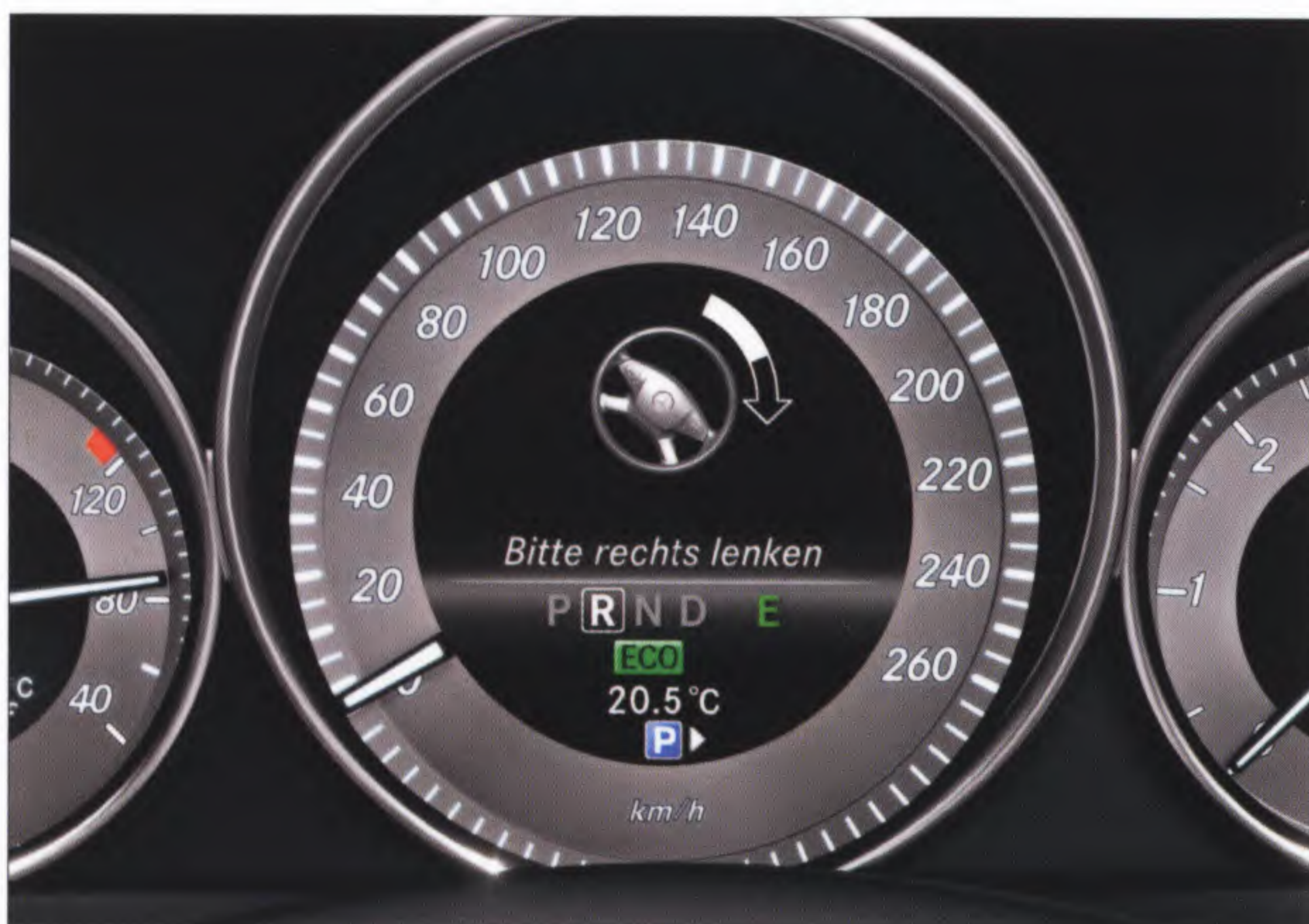
เซ็นเซอร์ช่วยในการนำรถเข้าจอด (PARKTRONIC) พร้อมแนะนำการจอดรถ (Parking Guidance)*
