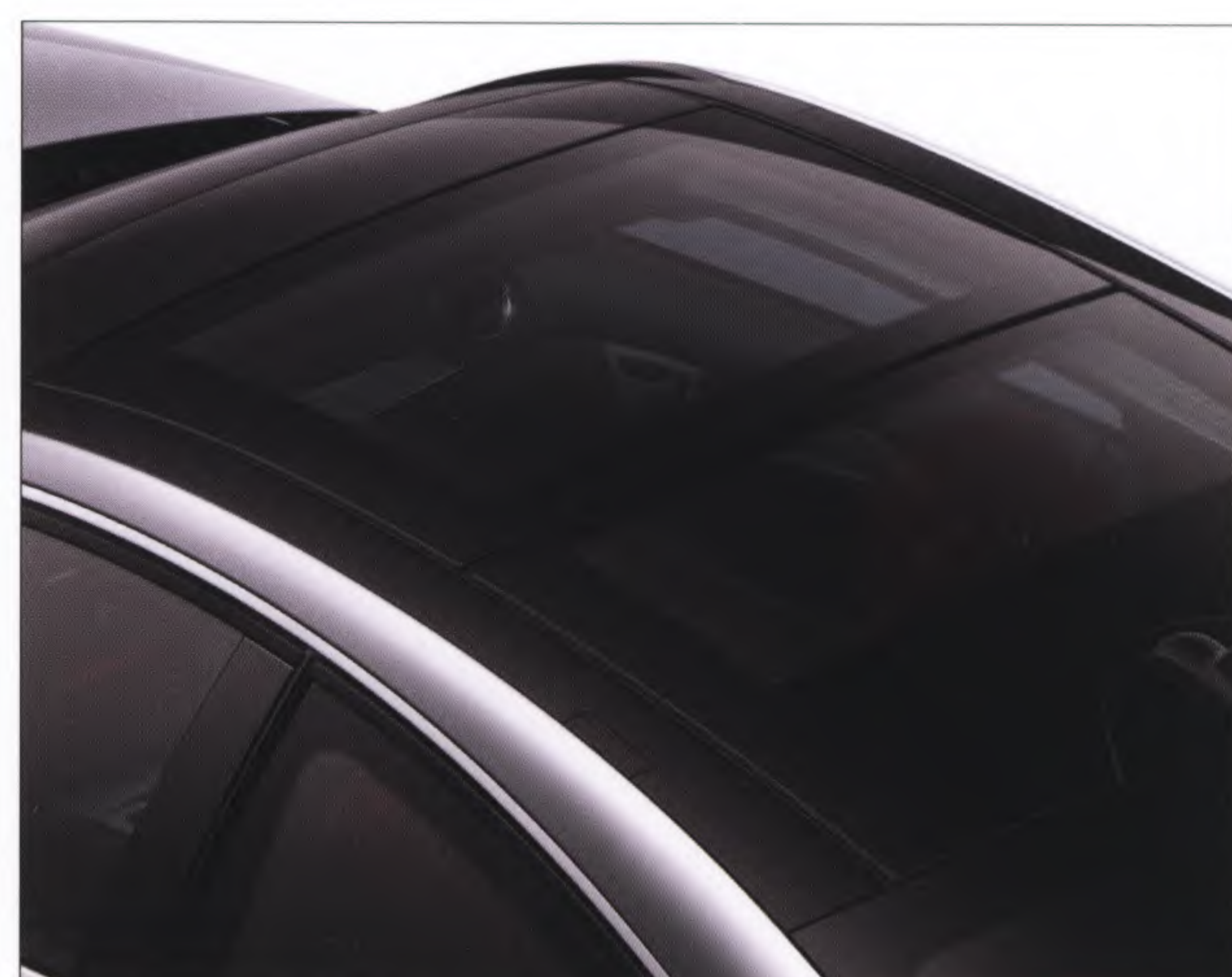
ชั้นรูปหลังคาแบบพาโนรามิก (panoramic glass sliding sunroof) เลื่อนเปิด - ปิดได้ด้วยระบบไฟฟ้า
