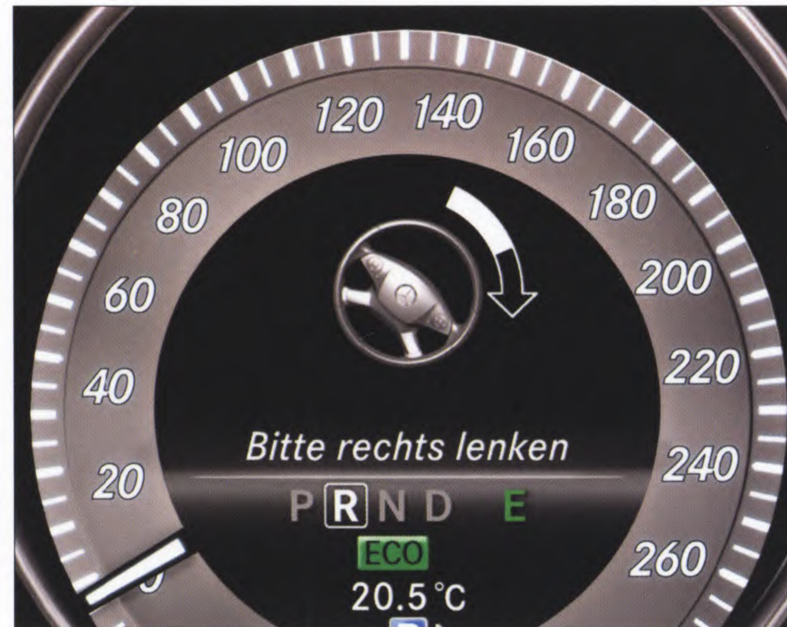
เซ็นเซอร์ช่วยในการนำรถเข้าจอด (PARKTRONIC) พร้อมแนะนำการจอดรถ
