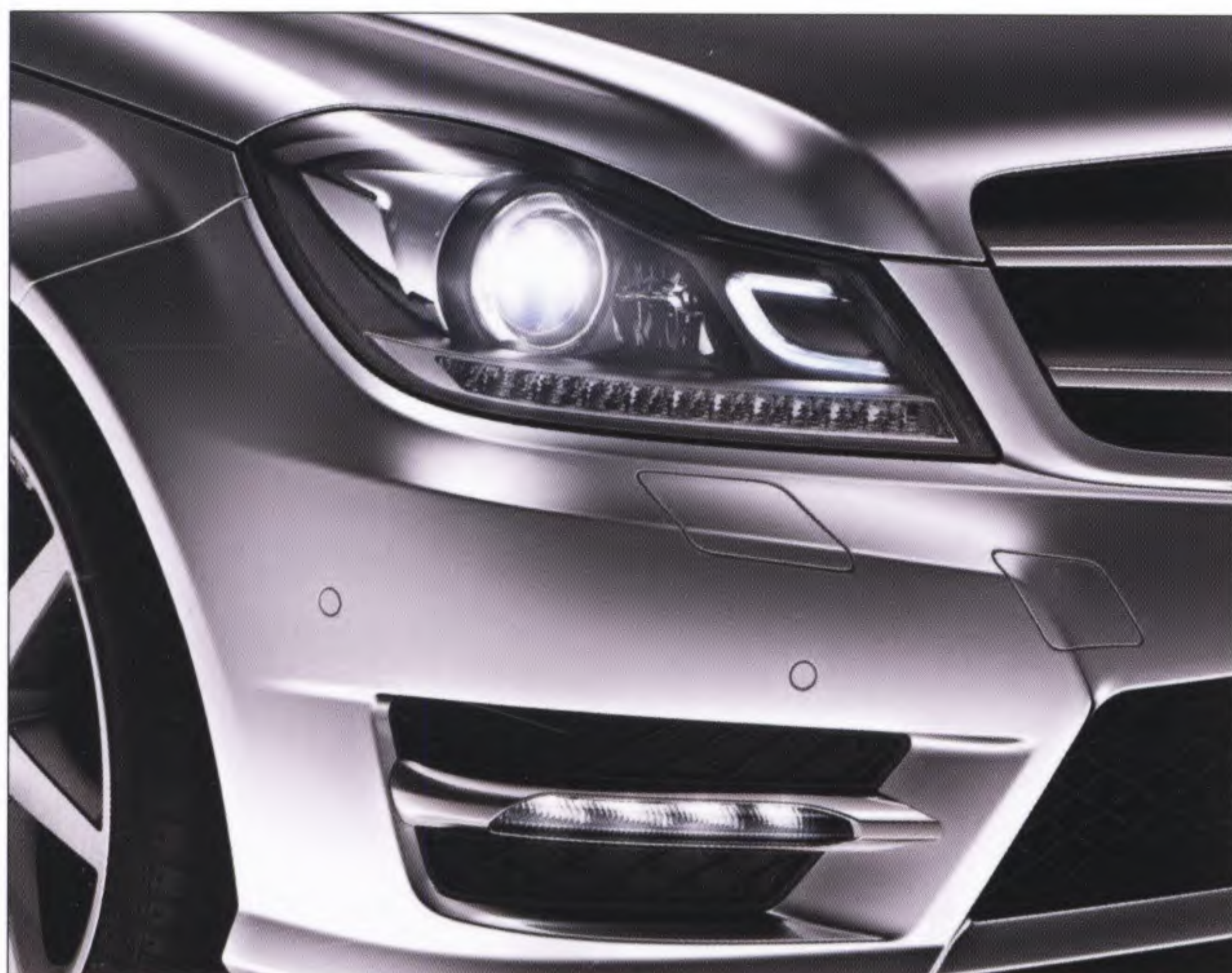
ไฟหน้าแบบไบซีนอน (bi-xenon) พร้อมระบบส่องสว่างอัจฉริยะ (ILS-Intelligent Light System)
