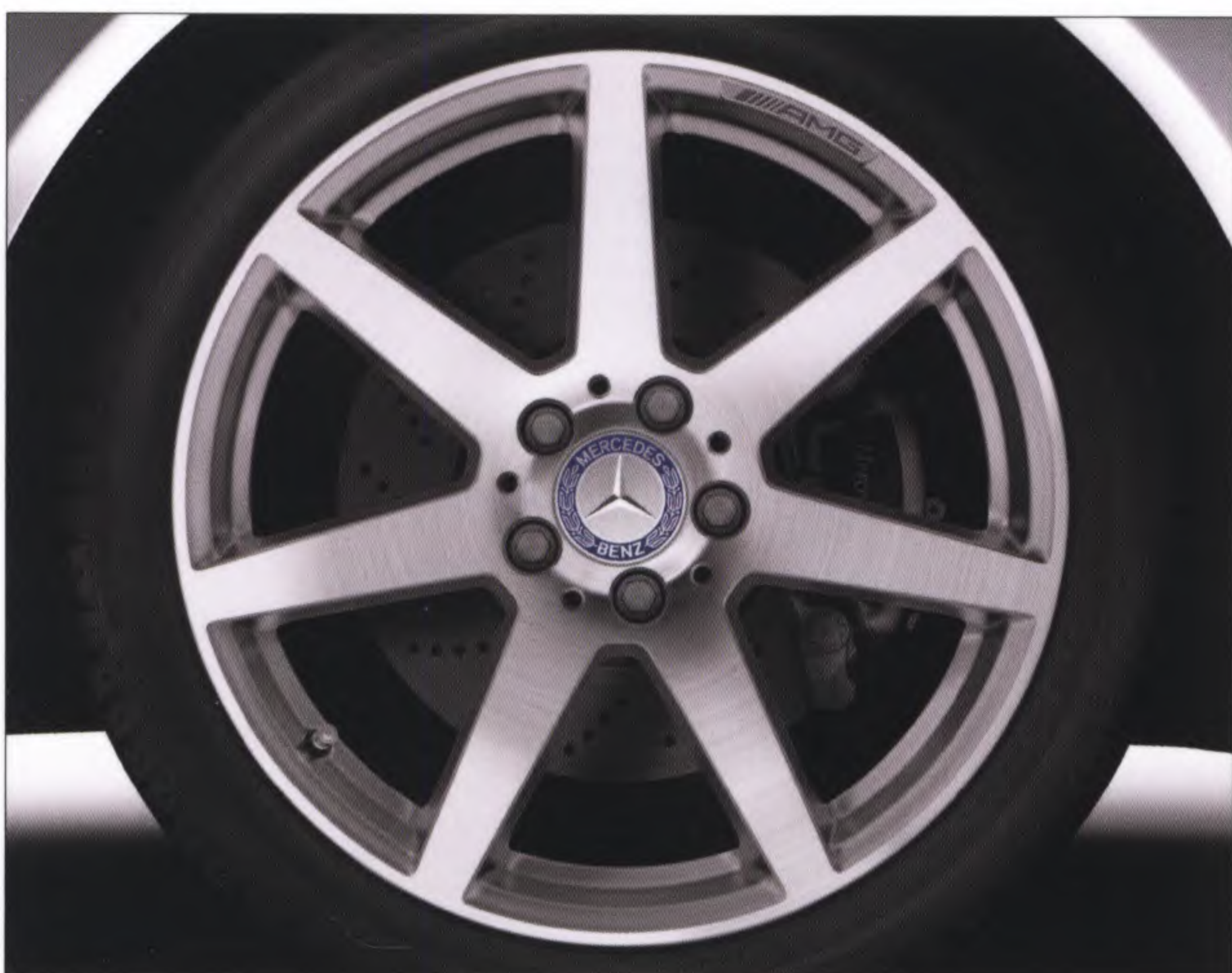
ล้ออัลลอยด์ดีไซน์สปอร์ตจาก AMG ขนาด 18" พร้อมยางหน้า 225/40 R18 และยางหลัง 255/35 R18
