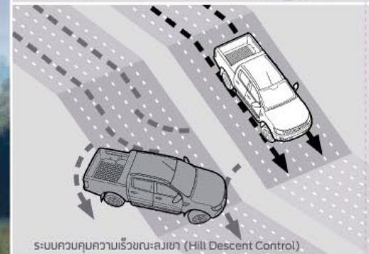
ระบบควบคุมความเร็วขณะลงเขา (Hill Descent Control)
