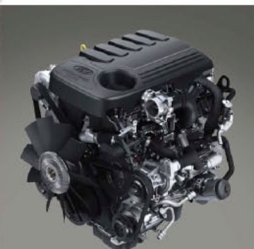
เครื่องยนต์ดีเซล TDCI 3.2L VG Turbo พร้อม Inter-Cooler กำลัง 200 แรงม้า / แรงบิด 470 นิวตันเมตร
