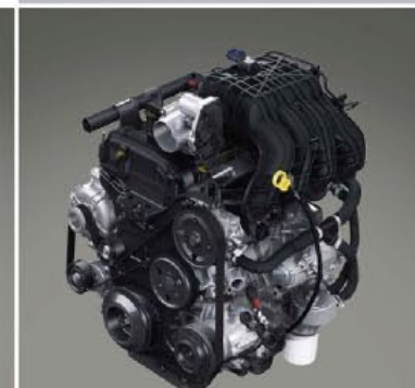
เครื่องยนต์เบนซิน 2.5 ลิตร กำลัง 166 แรงม้า / แรงบิด 226 นิวตันเมตร
