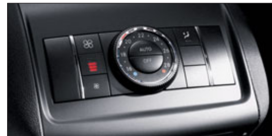
Über die Bedieneinheit im Fond können Wunschtemperaturen und Luftmenge präzise eingestellt werden.
