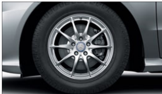
Leichtmetallrad im 10-Speichen-Design mit Bereifung 235/65 R 17 (Serie für R 300 CDI BlueEFFICIENCY, R 350 BlueTEC 4MATIC, Code 25R).
