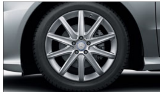
Leichtmetallrad im 10-Speichen-Design mit Bereifung 255/50 R 19 (optional, Serie für R 500 4MATIC, Code R26).
