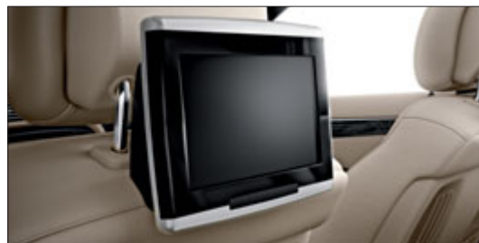
Die beiden Displays für das Fond-Entertainment sind an den Kopfstützen der Vordersitze angebracht.
