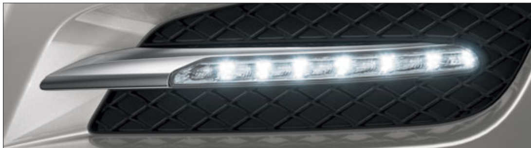
Das LED-Tagfahrlicht ermöglicht eine bessere Wahrnehmung durch andere Verkehrsteilnehmer.
