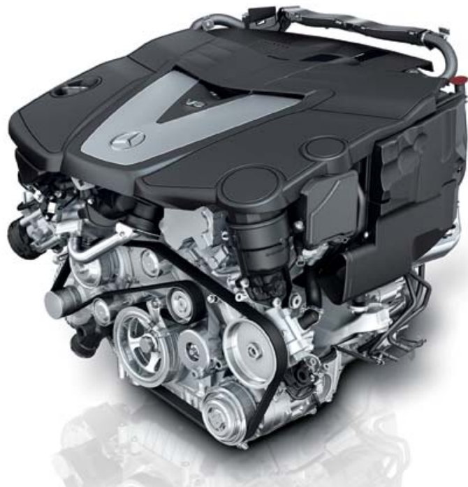
เครื่องยนต์ดีเซล ขนาด 3.0 ลิตร V6 24 วาล์ว เทอร์โบ พร้อมอินเตอร์คูลเลอร์ ผลิตจากมหาวิทยาลัยและพร้อมให้เรียกใช้งานได้อย่างต่อเนื่องในทุกสถานการณ์การขับขี่
