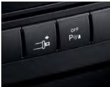
ระบบป้อนเข็มขัดนิรภัยอัตโนมัติ (automatic belt feeder) สั่งการทำงานได้จากสวิตช์บนแผงคอนโซลกลาง
