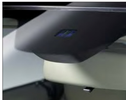
ใบปัดน้ำฝนทำงานอัตโนมัติ พร้อมเซ็นเซอร์วัดปริมาณน้ำฝน (rain sensor)
