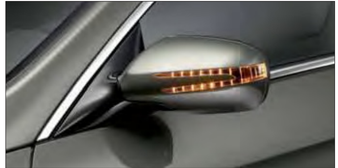
กระจกมองข้างพร้อมสัญญาณไฟเลี้ยวแบบ LED ปรับระดับและพับเก็บได้ด้วยระบบไฟฟ้า พร้อมระบบไล่ฝ้า และจะปรับมุมเลนกลงอัตโนมัติ เมื่อเกียร์อยู่ในตำแหน่งถอยหลัง
