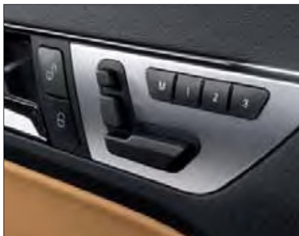
เบาะนั่งคู่หน้าปรับระดับด้วยระบบไฟฟ้า พร้อมหน่วยบันทึกความจำ
