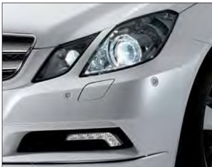
ไฟหน้าแบบไบซีนอน (bi-xenon) พร้อมไฟ daytime สำหรับการขับขี่ในเวลากลางวัน แบบ LED
