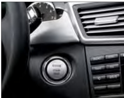
ระบบกุญแจแบบ KEYLESS-GO พร้อมสวิตช์สำหรับติด-ดับเครื่องยนต์
