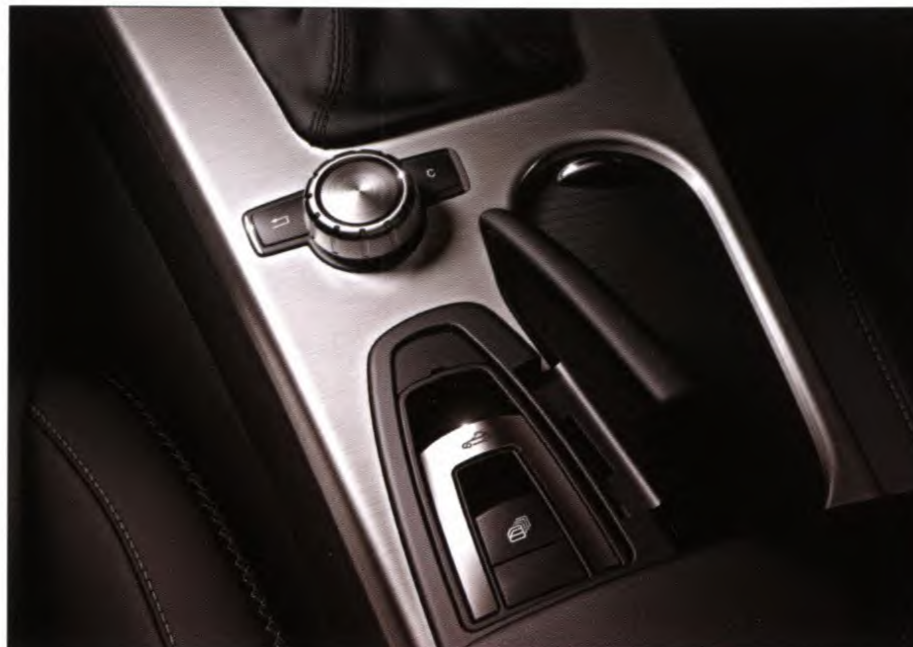
Controller และสวิตช์ควบคุมการเปิด-ปิดหลังคา อยู่เหนือพนักวางแขนบนคอนโซลกลาง
