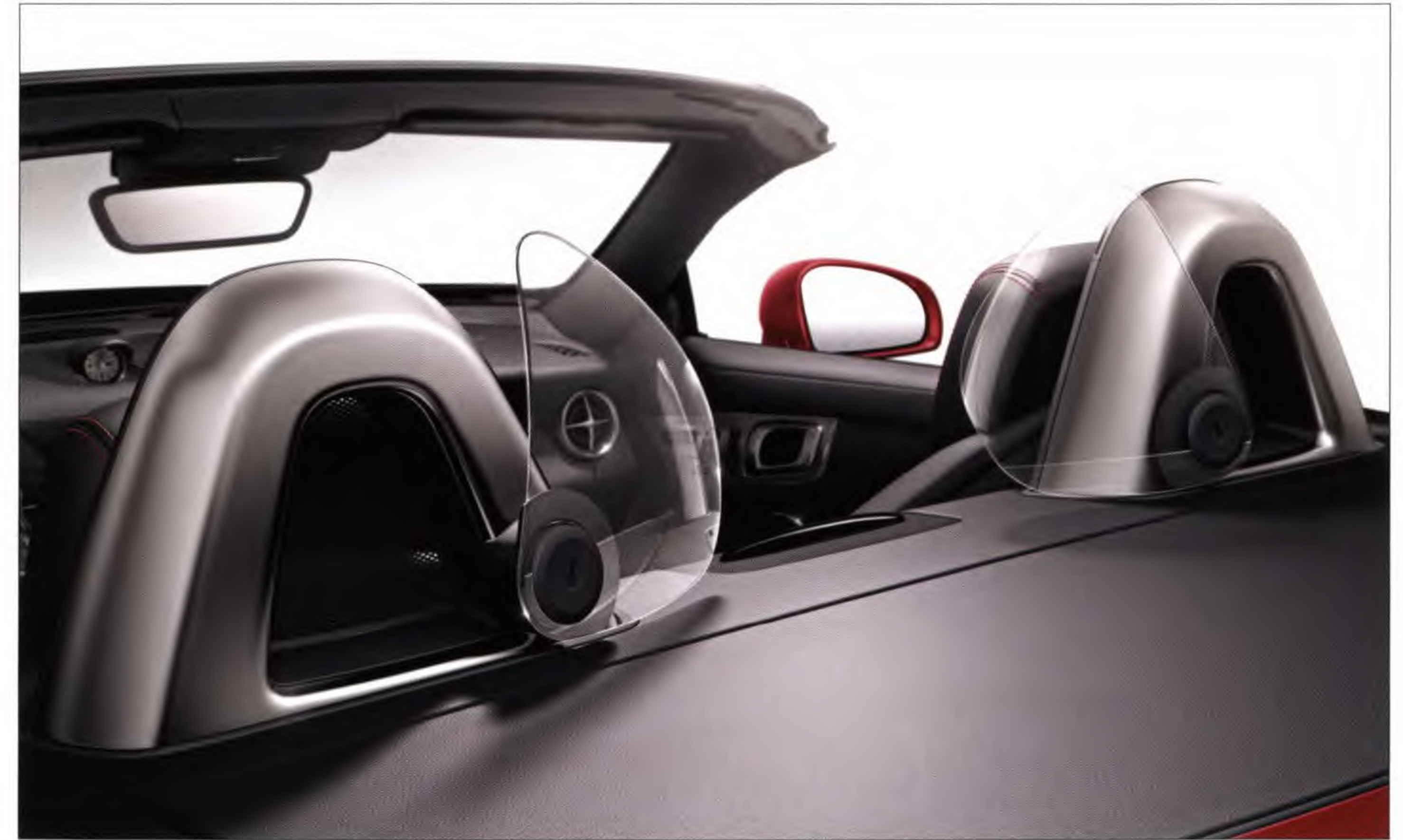
แผ่นกันลม (AIRGUIDE) นวัตกรรมล่าสุดที่ป้องกันลมหมุนวนภายในห้องโดยสาร
