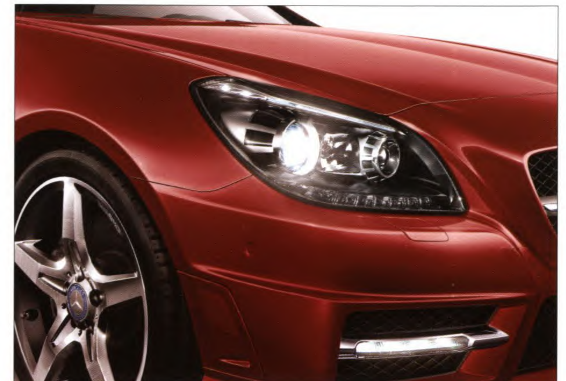
ไฟหน้าแบบไบซีนอน (bi-xenon) และไฟ daytime สำหรับการขับขี่ในเวลากลางวัน แบบ LED
