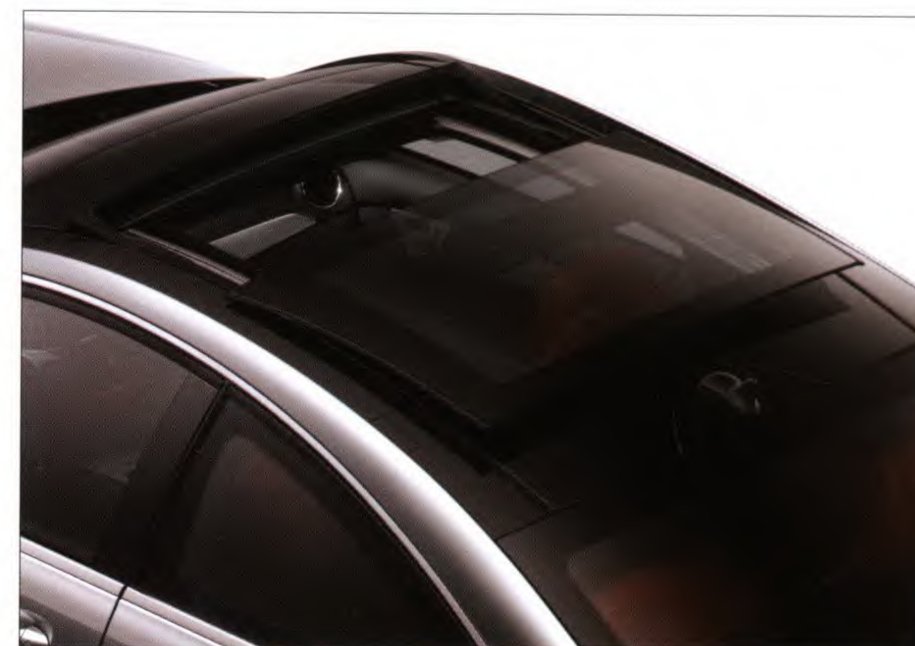
ชั้นรูลหลังคาแบบพาโนรามิก (panoramic glass sliding sunroof) เลื่อนเปิด-ปิดได้ด้วยระบบไฟฟ้า
