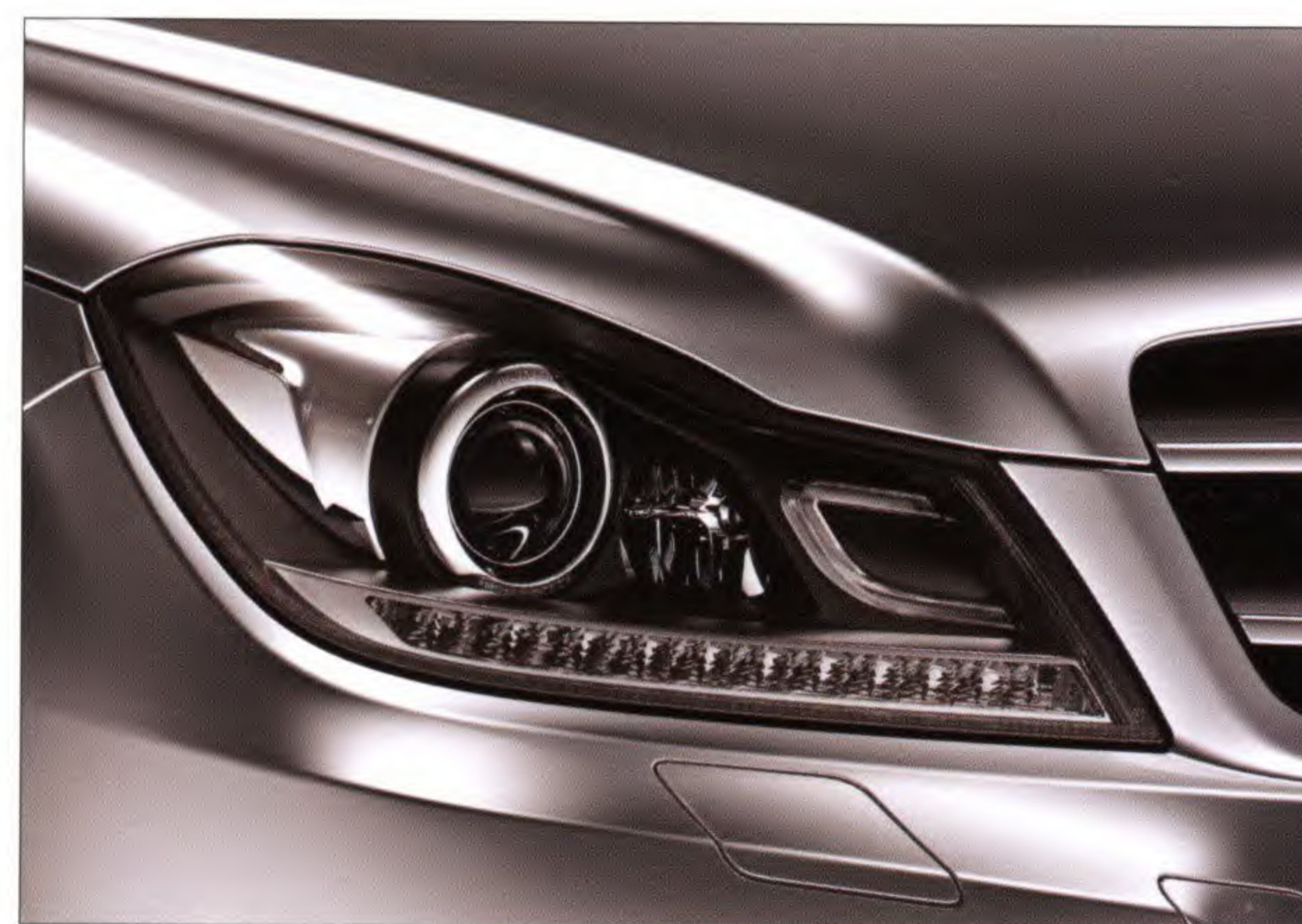
ไฟหน้าแบบไบซีนอน (bi-xenon) พร้อมระบบส่องสว่างอัจฉริยะ (ILS-Intelligent Light System)
