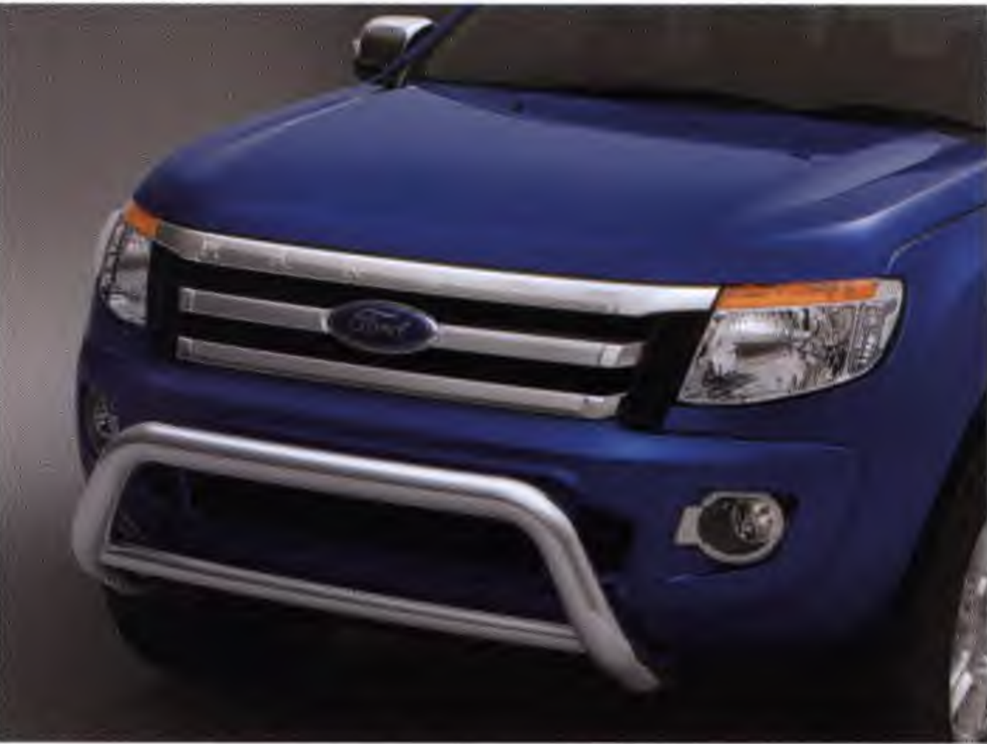
ชุดกันชนเสริมด้านหน้า เพิ่มความสปอร์ตและช่วยปกป้องกันชนหน้า ผ่านการทดสอบการชนโดยไม่มีผลกระทบต่อการทำงาน ของถุงลมนิรภัยด้านหน้า
