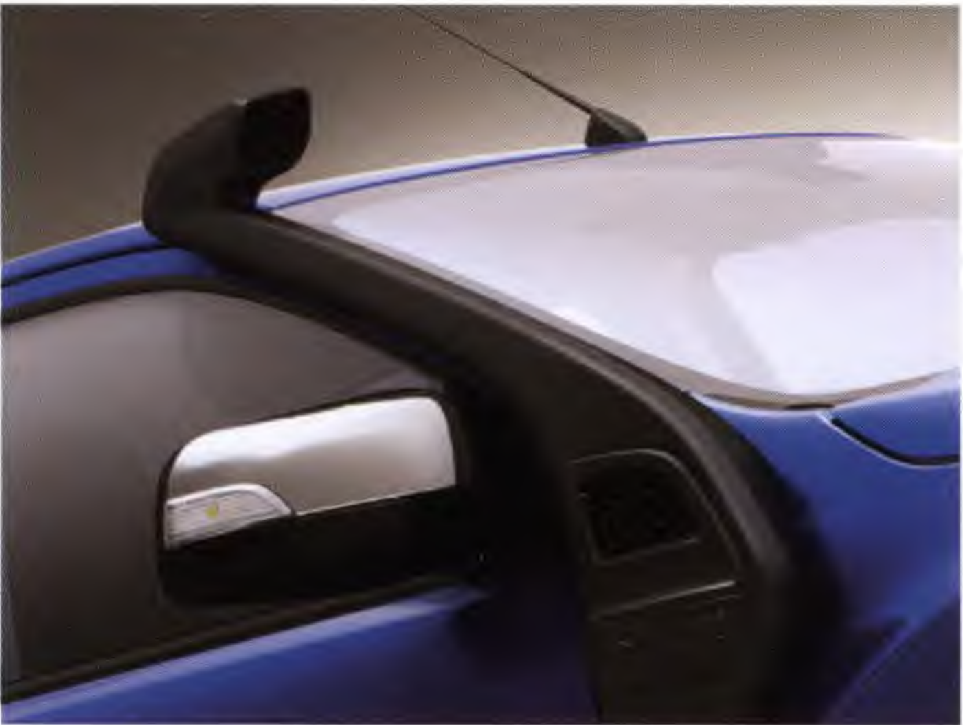
ชุดท่อไอเสียอากาศเข้า ช่วยปรับเปลี่ยนตำแหน่งท่อดูดอากาศเข้าเครื่องยนต์ ให้สูงขึ้น เพิ่มความสามารถในการขับขี่ผ่านบริเวณ ที่มีระดับน้ำสูงกว่า 80 ซม.
