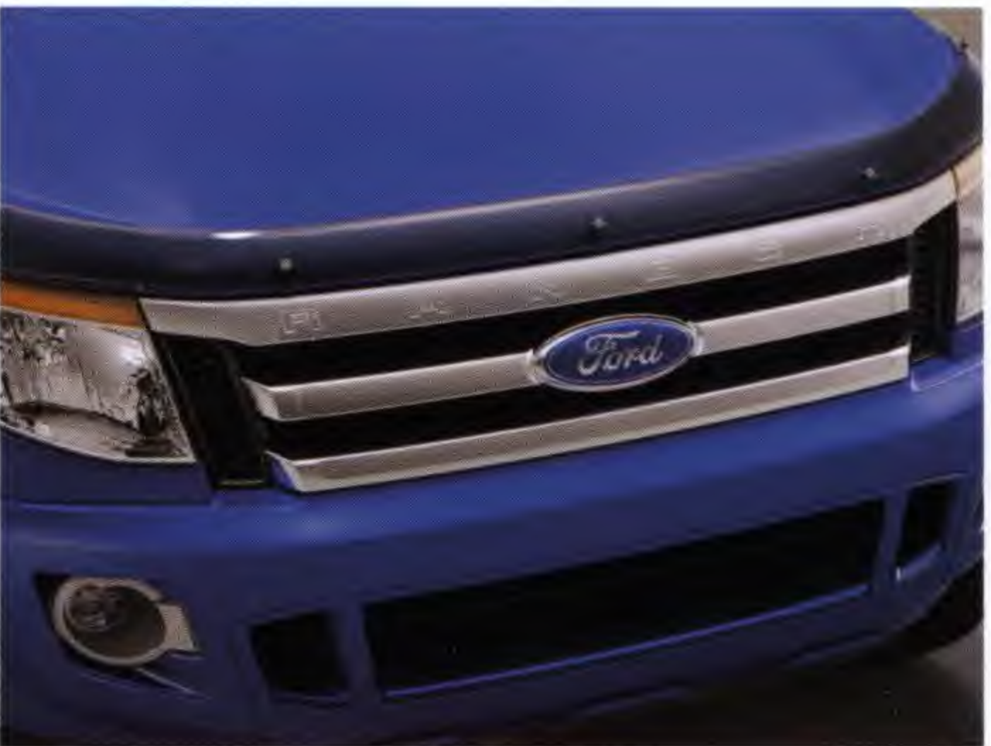
กันแมลงฟากระโปรงหน้า ช่วยปกป้องฟากระโปรงหน้าจากเศษหินและแมลง ผ่านการออกแบบและทดสอบเพื่อลดเสียงรบกวน จากลมปะทะระหว่างการขับขี่
