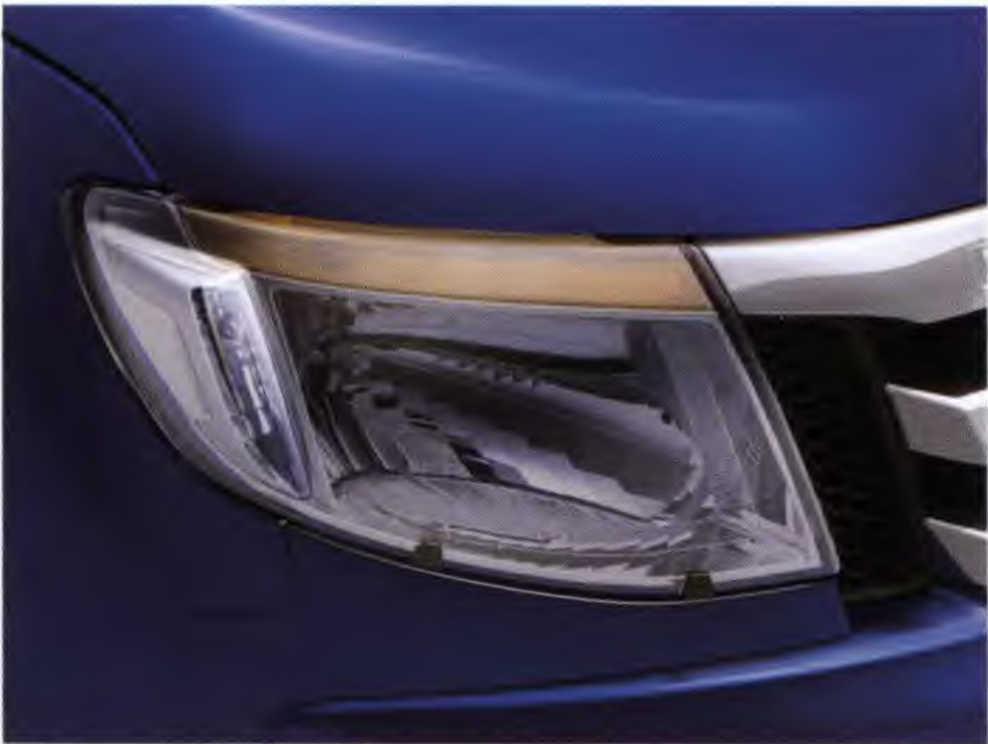
ชุดครอบกันกระแทกโคมไฟหน้า เพิ่มความสปอร์ต ช่วยปกป้องโคมไฟหน้าจากเศษหิน และไม่มีผลกระทบต่อการกระจายแสงของไฟหน้า
