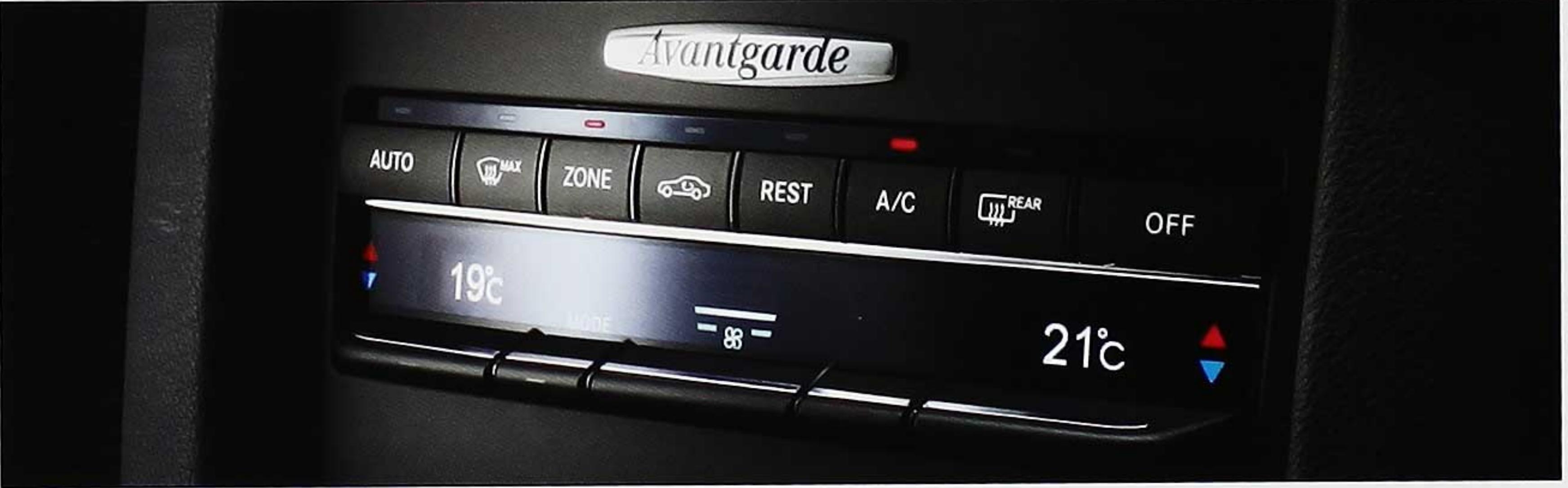
สวิตช์ควบคุมการทำงานของระบบควบคุมอุณหภูมิอัตโนมัติ แบบ 3-zone (THERMOTRONIC) ถูกออกแบบให้เข้าถึงและใช้งานได้ง่ายเพียงปลายนิ้วสัมผัส เช่นเดียวกับการปรับเปลี่ยนอุณหภูมิ
