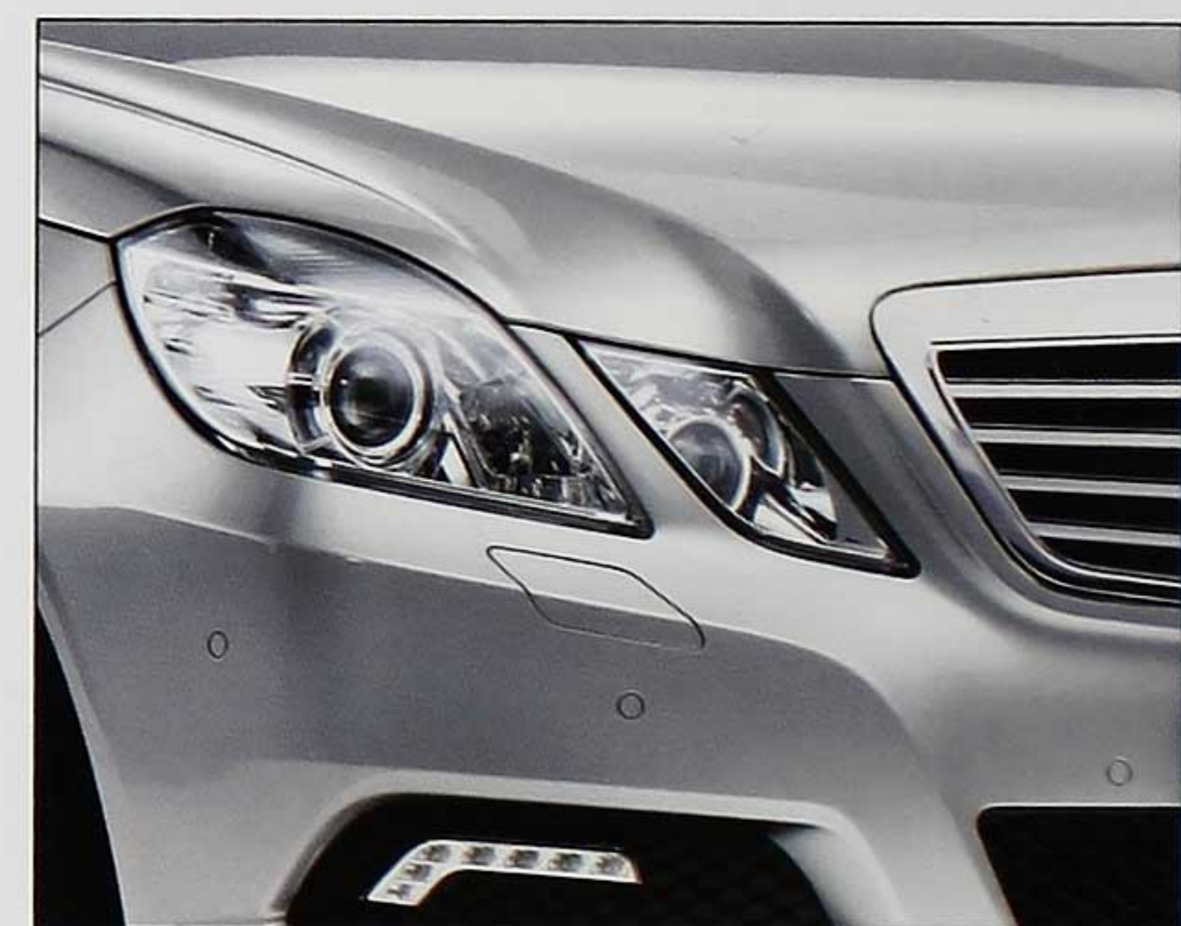
ไฟหน้าแบบไบซีนอน (bi-xenon) พร้อมระบบฉีดน้ำทำความสะอาดไฟหน้า และไฟสำหรับการขับขี่ในเวลากลางวัน แบบ LED*
