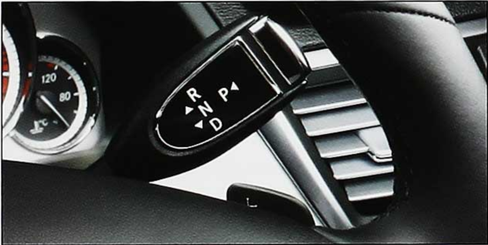
ก้านเกียร์แบบ DIRECT SELECT ที่คอปวงมาลัย สำหรับเกียร์อัตโนมัติเดิหน้าแบบ 7 จังหวะ (7G-TRONIC) มอบความสะดวกสบายมากยิ่งขึ้น
