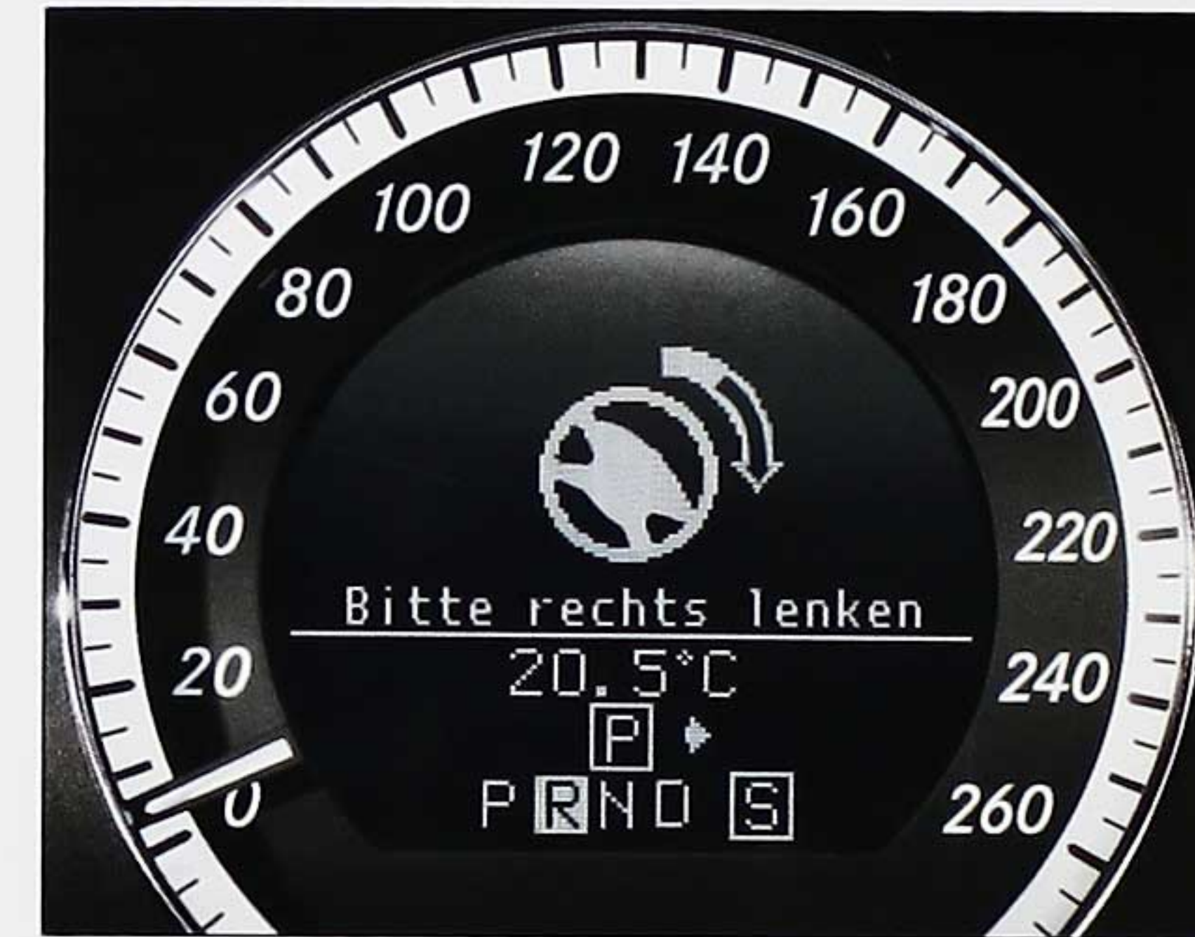
เซ็นเซอร์ช่วยในการนำรถเข้าจอด (PARKTRONIC) พร้อมแนะนำวิธีการจอดรถ (Parking Guidance)
