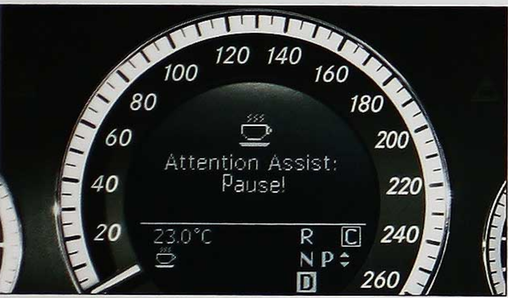
หากระบบฯ ตรวจสอบว่าผู้ขับขี่เริ่มมีอาการเหนื่อยล้า ก็จะส่งสัญญาณเสียงและภาพเตือนทันที เพื่อแนะนำให้ผู้ขับขี่หยุดพัก
