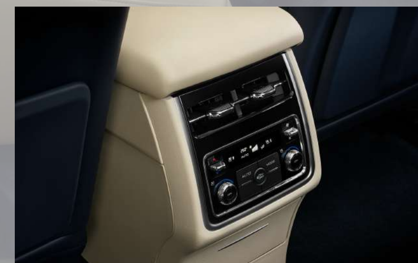
2 nd Row Ventilation Control Panel ระบบควบคุมการระบายอากาศ และระบายความร้อนเบาะแถวที่ 2
