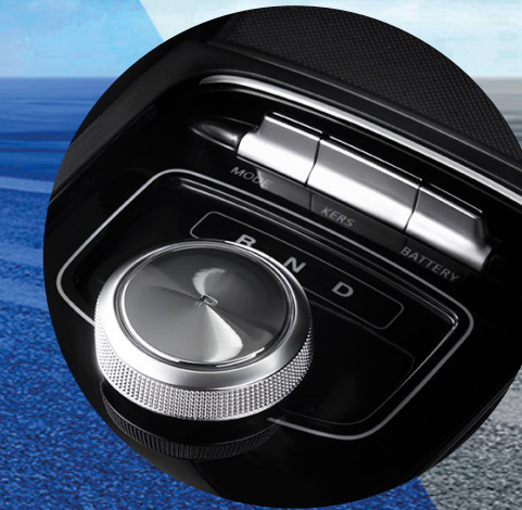
KERS MODE จะช่วยให้การชาร์จพลังงานกลับเข้าสู่แบตเตอรี่ ในขณะที่ชะลอรถ โดยสามารถตั้งค่าได้ 3 ระดับ (มาก ปานกลาง และน้อย)
