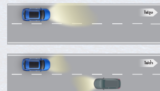
IHC (INTELLIGENT HIGH-BEAM CONTROL) เปิด - ปิดไฟสูงอัตโนมัติ ระหว่างขับขี่ในที่มืด ระบบ จะเปิดไฟสูงอัตโนมัติ และหากตรวจพบว่ามีรถคัน อื่นสวนทางมา ระบบจะปรับไฟสูงเป็นไฟต่ำอัตโนมัติ เพื่อให้แสงไฟรบกวนรถที่สวนทาง
