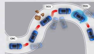
CBC (CURVE BRAKE CONTROL), SCS (STABILITY CONTROL SYSTEM), TCS (TRACTION CONTROL SYSTEM) เข้าใจได้อย่างมั่นใจด้วยระบบควบคุมการเบรก ในขณะที่เข้าโค้ง CBC ที่ทำงานควบคู่กับระบบ ควบคุมการทรงตัว SCS เมื่อต้องหลบสิ่งกีดขวาง กะทันหัน และระบบป้องกันล้อหมุนฟรี TCS เพื่อ ไม่ให้เกิดการไถลออกนอกเส้นทางขณะเร่งออกจาก โค้งแบบกะทันหัน
