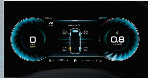
ระบบ TPMS สำหรับตรวจสอบความผิดปกติของลมยาง
