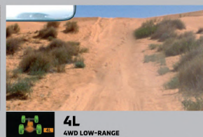
4L 4WD LOW-RANGE ระบบขับเคลื่อน 4 ล้อ ที่ความเร็วต่ำ สำหรับเส้นทางวิบาก ลุยโคลน เส้นทางแบบมีเนินหินสลับหรือมีความลาดชันมากๆ
