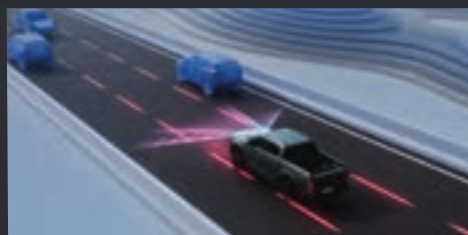
ใหม่! LKAS (Lane Keep Assist System) ระบบช่วยควบคุมรถให้อยู่ในเลน
