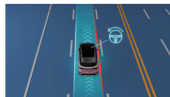
Lane Departure Prevention (LDP) ระบบป้องกันรถเบี่ยงออกนอกเลน
