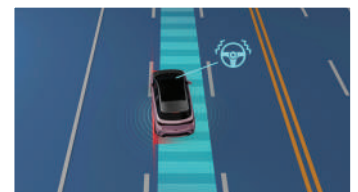
Lane Departure Warning (LDW) ระบบช่วยเตือนเมื่อรถออกนอกเลน
