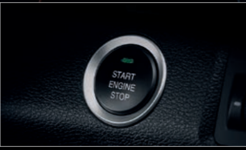
ปุ่ม PUSH START ทำงานร่วมกับระบบกุญแจนิรภัย IMMOBILIZER
