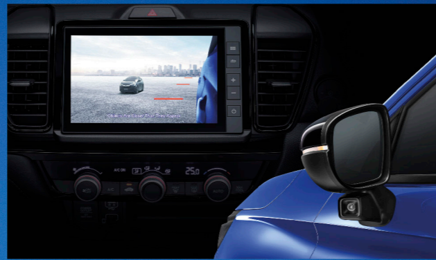
Honda LaneWatch ระบบแสดงภาพมุมมองสายตายขณะเปลี่ยนเลน
