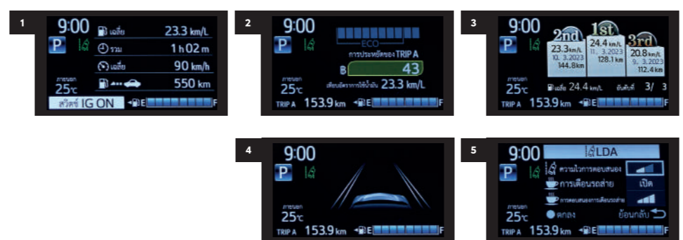
มาตรวัดแบบเรืองแสง พร้อมจอแสดงผลข้อมูลการขับขี่แบบจอสี่ TFT ขนาด 4.2 นิ้ว
