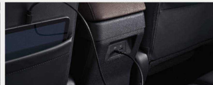
◆ FRONT USB-A & 2 nd ROW SEAT USB-A AND USB-C CHARGER ช่องต่ออุปกรณ์ USB-A เชื่อมต่อความบันเทิงด้านหน้า และช่องต่อ USB-A, USB-C สำหรับชาร์จไฟบริเวณแถวสอง
