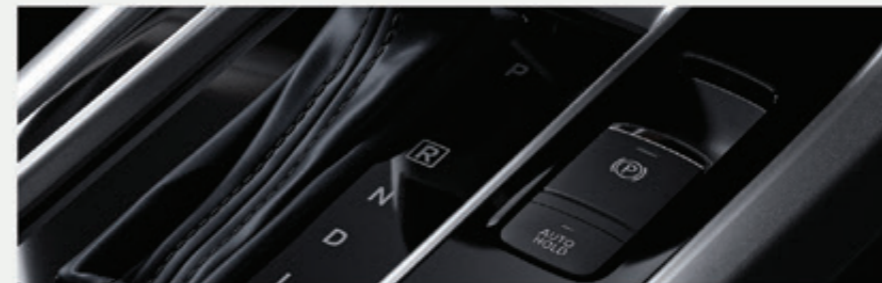
◆ ELECTRIC AUTO PARKING BRAKE WITH BRAKE AUTO HOLD* ระบบเบรกมือไฟฟ้าอัตโนมัติ พร้อมระบบ Brake Auto Hold สะดวกสบายมากยิ่งขึ้น ไม่ต้องเหยียบเบรกค้างเมื่อจอดสภาพการจราจรติดขัด
