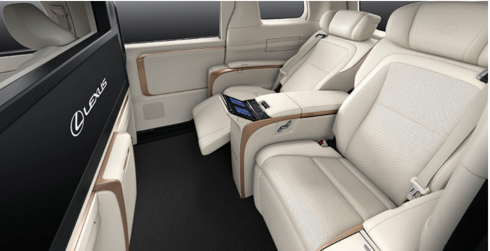
RELAXATION FUNCTION Air bladders within the seat's back and cushions can inflate and deflate to apply pressure on a passenger's body, from thighs to shoulders. Seven unique programs (each lasting 15 minutes) and five pressure levels enable a relaxing experience to suit any given mood. ฟังก์ชันที่ช่วยให้คุณผ่อนคลาย ระบบวดภายในเบาะพนักพิงและเบาะรองนั่งสามารถขยายตัวและยุบตัวเพื่อส่งแรงกดบนร่างกายของผู้โดยสารตั้งแต่สะโพกถึงหัวไหล่ให้คุณได้สัมผัสประสบการณ์อันผ่อนคลายที่เหมาะสมกับทุกอารมณ์ด้วยโปรแกรมถึง 7 โปรแกรมที่ไม่ซ้ำกันพร้อมเลือกแรงดันได้ 5 ระดับ (แต่ละโปรแกรมใช้เวลา 15 นาที)
