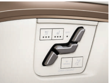
RELAXATION FUNCTION Air bladders within the seat's back and cushions can inflate and deflate to apply pressure on a passenger's body, from thighs to shoulders. Seven unique programs (each lasting 15 minutes) and five pressure levels enable a relaxing experience to suit any given mood. ฟังก์ชันที่ช่วยให้คุณผ่อนคลาย ระบบวดภายในเบาะพนักพิงและเบาะรองนั่งสามารถขยายตัวและยุบตัวเพื่อส่งแรงกดบนร่างกายของผู้โดยสารตั้งแต่สะโพกถึงหัวไหล่ให้คุณได้สัมผัสประสบการณ์อันผ่อนคลายที่เหมาะสมกับทุกอารมณ์ด้วยโปรแกรมถึง 7 โปรแกรมที่ไม่ซ้ำกันพร้อมเลือกแรงดันได้ 5 ระดับ (แต่ละโปรแกรมใช้เวลา 15 นาที)
