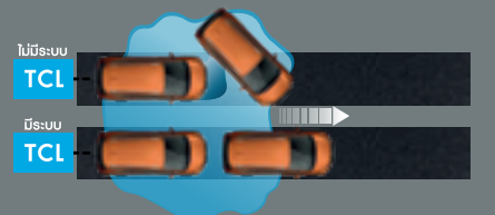
TRACTION CONTROL SYSTEM (TCL) ระบบป้องกันล้อหมุนฟรี และควบคุมการลื่นไถลระบบจะควบคุมการหมุนของล้ออย่างสมดุลในสภาวะถนนลื่น เพื่อไม่ให้รถสูญเสียการยึดเกาะบนถนน
