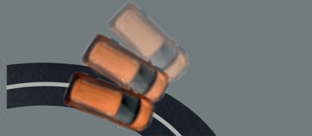
ACTIVE STABILITY CONTROL (ASC) ระบบควบคุมเสถียรภาพการทรงตัวในสภาวะที่รถเสียสมดุล เพื่อป้องกันการลื่นไถลออกนอกเส้นทางเมื่อเข้าโค้งด้วยความเร็วสูง ถนนลื่น หรือหักหลบกะทันหัน เพื่อไม่ให้รถสูญเสียการยึดเกาะถนน
