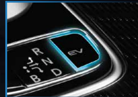
EV Switch ปรับเปลี่ยนโหมดเพื่อขับเคลื่อนด้วยไฟฟ้า เพียงอย่างเดียว เที่ยง และประหยัดพลังงาน
