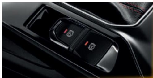
ระบบเบรกมือไฟฟ้า EPB และระบบป้องกันการไหลของรถโดยไม่ต้องเหยียบเบรกค้าง AVH
