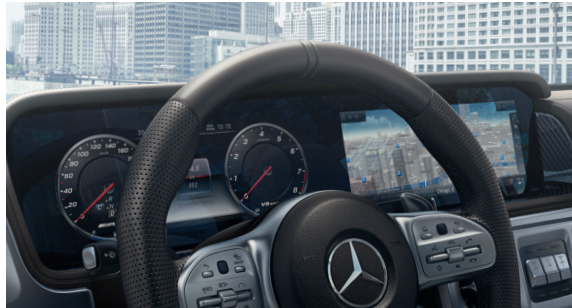
หน้าจอแสดงข้อมูลการขับขี่แบบ All-Digital Instrument Display ขนาด 12.3 นิ้ว
