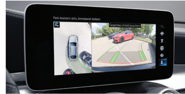
เซ็นเซอร์ช่วยในการนำรถเข้าจอด (PARKTRONIC) และกล้องแสดงภาพแบบรอบทิศทาง (360° Camera)
